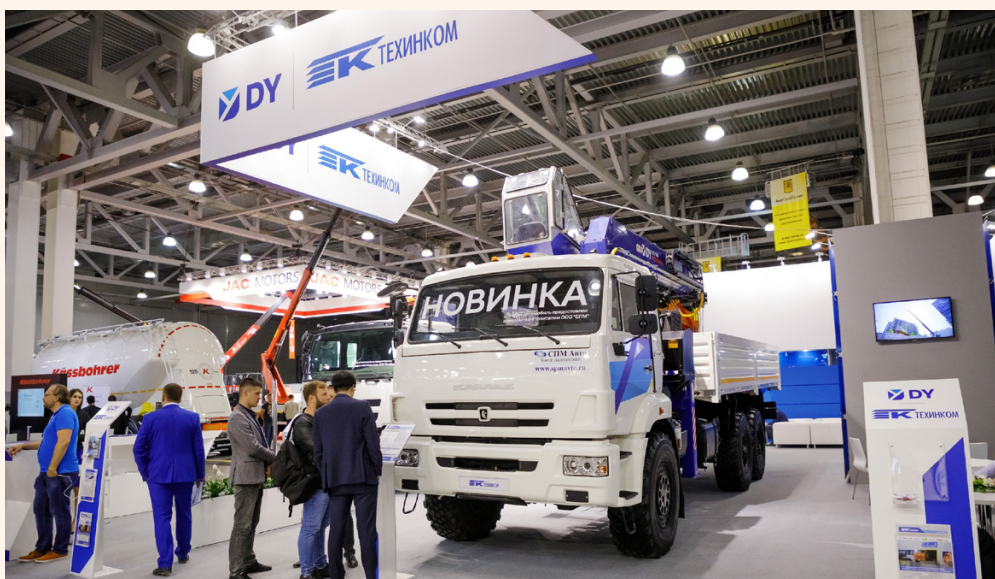
«ТЕХИНКОМ» показал новинку 2018 года — крано-манипуляторную установку DY SS1966 с грузовым моментом 19 тм, смонтированную на шасси КАМАЗ-43118
