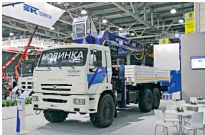
Автомобиль мод. 732407 на шасси КАМАЗ-43118 с КМУ DY SS1966 с полностью закрытой кабиной оператора (монтаж надстройки произведен ООО «Строительные подъемные машины»)
