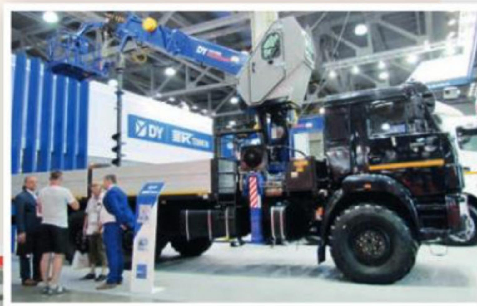
Одна из наиболее востребованных и универсальных краноманипуляторных установок на российском рынке - DY SS1966, с грузовым моментом 19 тм. Она обладает двухконтурной гидравлической системой с раздельными клапанами для бурения и для подъема груза. Отрицательный угол наклона стрелы позволяет работать с грузами, находящимися в ямах, котлованах или траншеях. Чтобы обеспечить комфорт оператора в ненастную погоду, КМУ DY SS1966 оборудована предназначенной для него закрытой кабиной.
