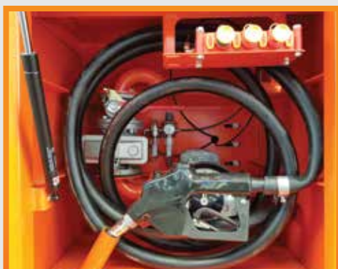
Узел выдачи топлива
