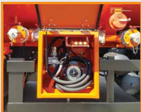
Узел выдачи топлива
