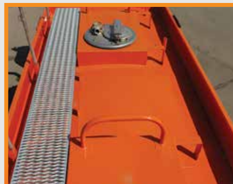
Площадка обслуживания и заливные горловины
