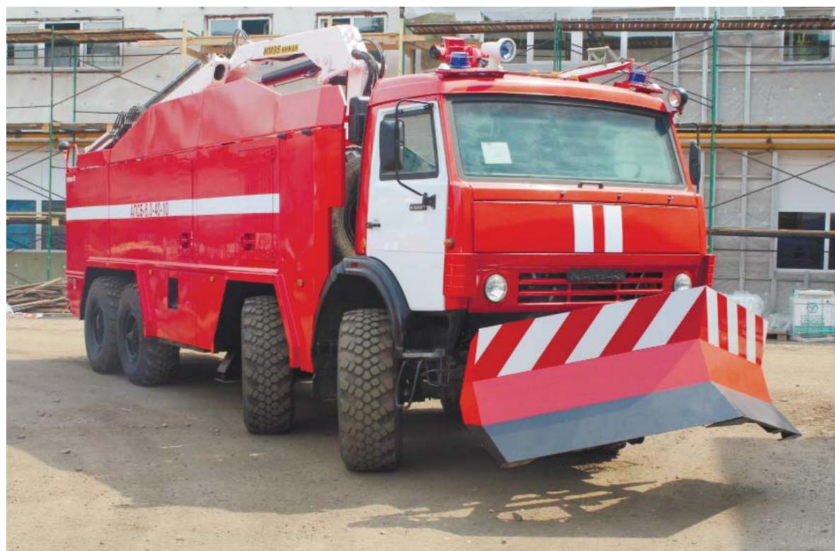
Машина с нуля спроектирована конструкторской группой ПСЦ на шасси КАМАЗ-63501 (8x8), оснащенный 12-литровым двигателем 740.50-360 мощностью 360 л.с.
