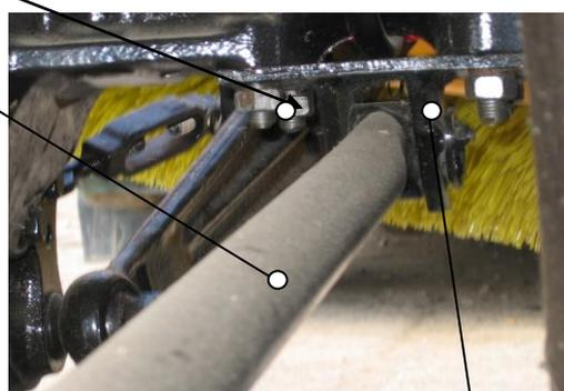
Приварить кронштейны (поз.16, рис.8) для установки ресивера на правую по ходу движения стойку, установить ресивер и подключить к системе трактора.
