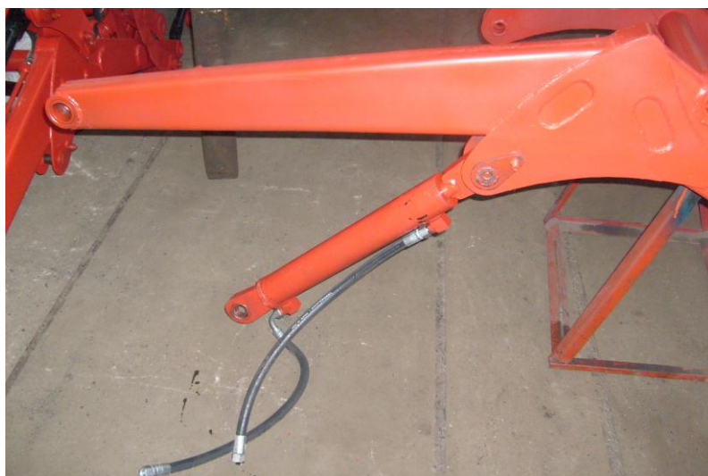
Рисунок 8. Установка стреловых гидроцилиндров.
