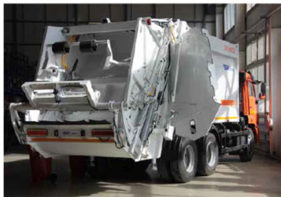
Мусоровоз МКЗ-50-18 на шасси КАМАЗ-65115 оборудован опрокидывателем для опорожнения контейнеров объёмом до 1,1 кубометра
