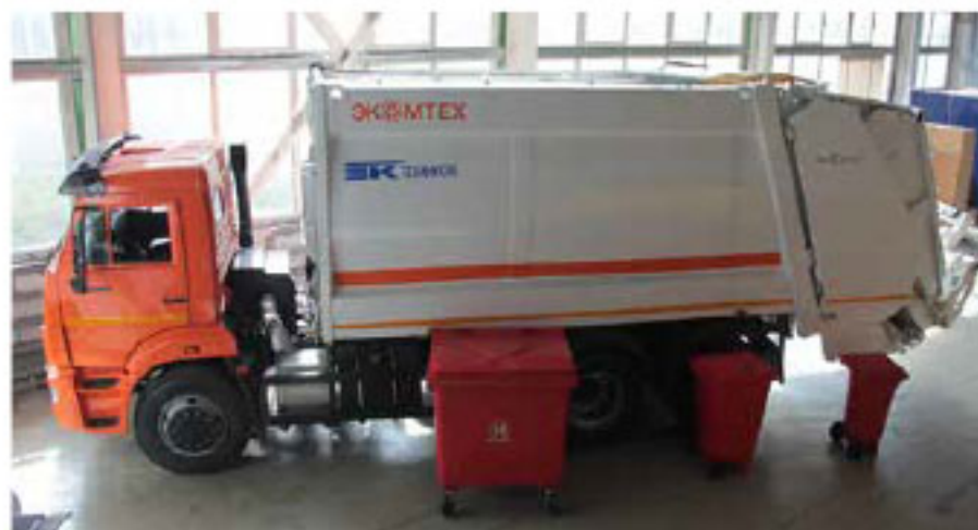
Мусоровоз МКЗ-50-18 на шасси КАМАЗ-65115 оборудован опрокидывателем для опорожнения контейнеров объёмом до 1,1 кубометра
